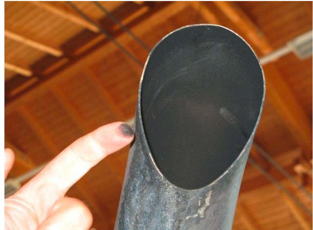
Pot d'échappement couvert de suie d'une machine agricole équipée d'un système RCS de niveau IIIB
