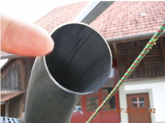
Pot d'échappement propre d'un véhicule communal équipé d'un filtre à particules
