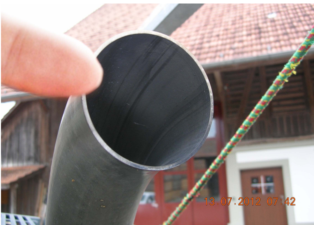
Scappamento pulito di una macchina comunale dotata di sistema di filtro antiparticolato
