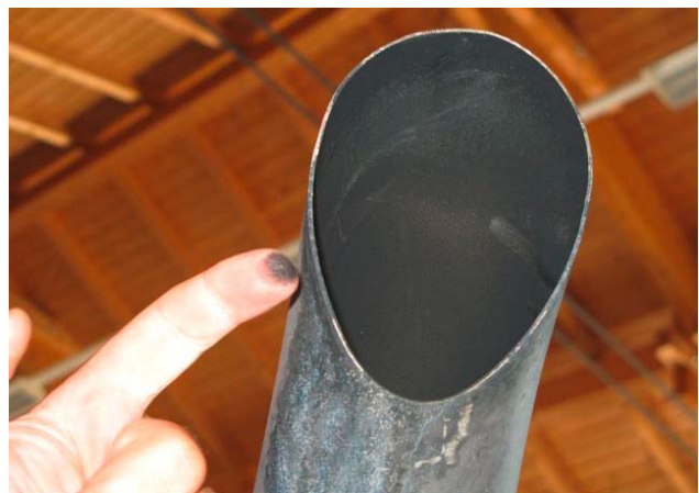
Scappamento fuliginoso di una macchina agricola dotata di sistema SCR conforme allo standard IIIB
