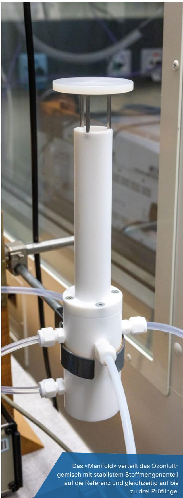
Das «Manifold» verteilt das Ozonluftgemisch mit stabilem Stoffmengenanteil auf die Referenz und gleichzeitig auf bis zu drei Prüflinge.
