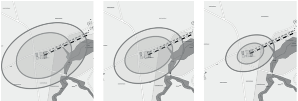
Abb. 3: kritische Distanz: Critical Loads (innerer Kreis), Critical Levels (äusserer Kreis). Ausgangslage ohne Massnahmen (links), mit Biowäscher nur beim Neubau (Mitte), mit Biowäscher bei Alt- und Neubau (rechts).
