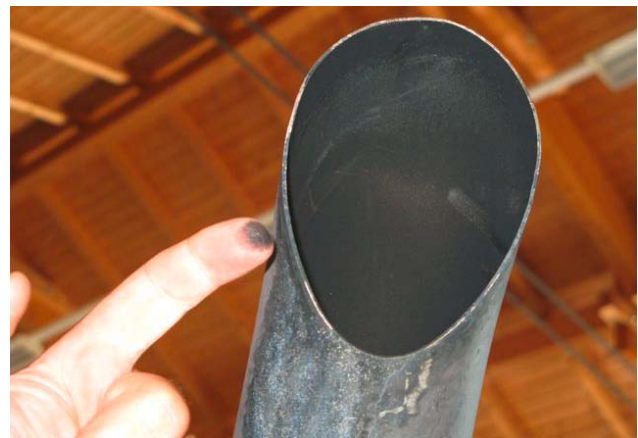
Russiger Auspuff einer Landmaschine mit SCR-System, welche die Abgasstufe IIIB erfüllt
