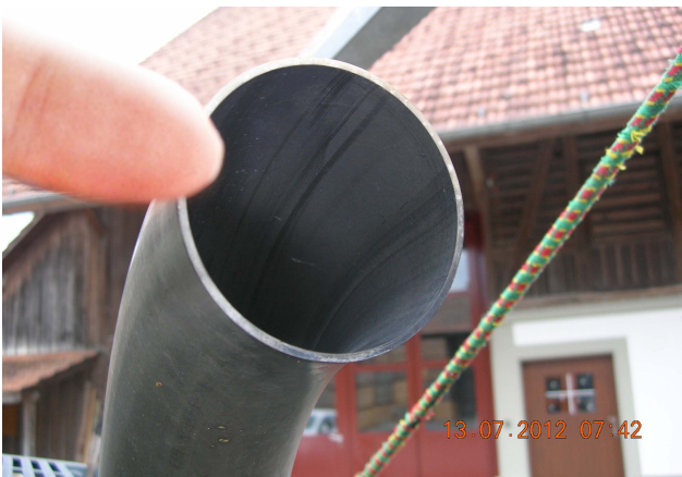
Sauberer Auspuff einer Kommunalmaschine mit Partikelfiltersystem
