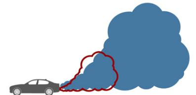
Mittlere NO<sub>x</sub>-Emission von Euro 6-Dieselfahrzeugen unter realen Fahrbedingungen (ausgefüllte Wolke). Rot umrandet ist der Grenzwert aus der Typenprüfung.
